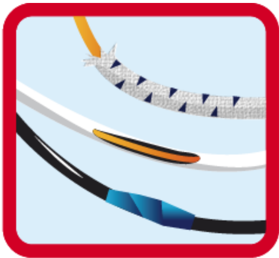
Нарушение изоляции на токопроводящих частях
